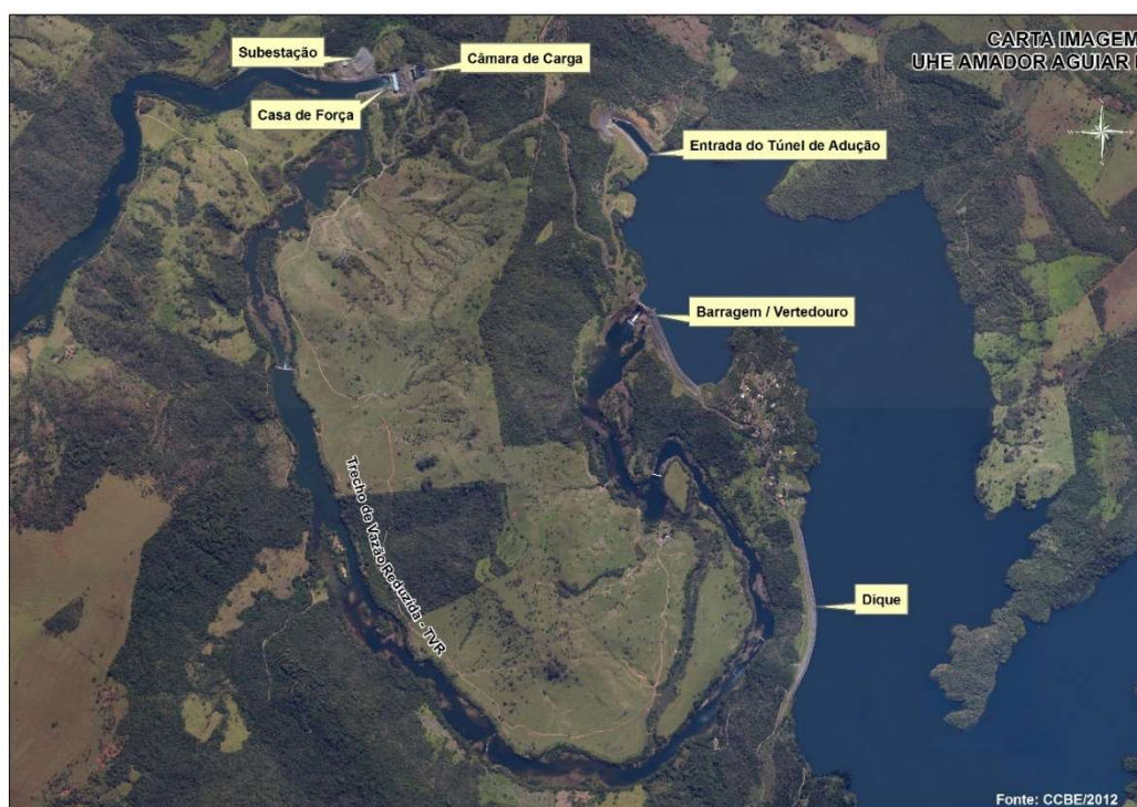
Figura 01– Arranjo Geral da UHE Amador Aguiar I
