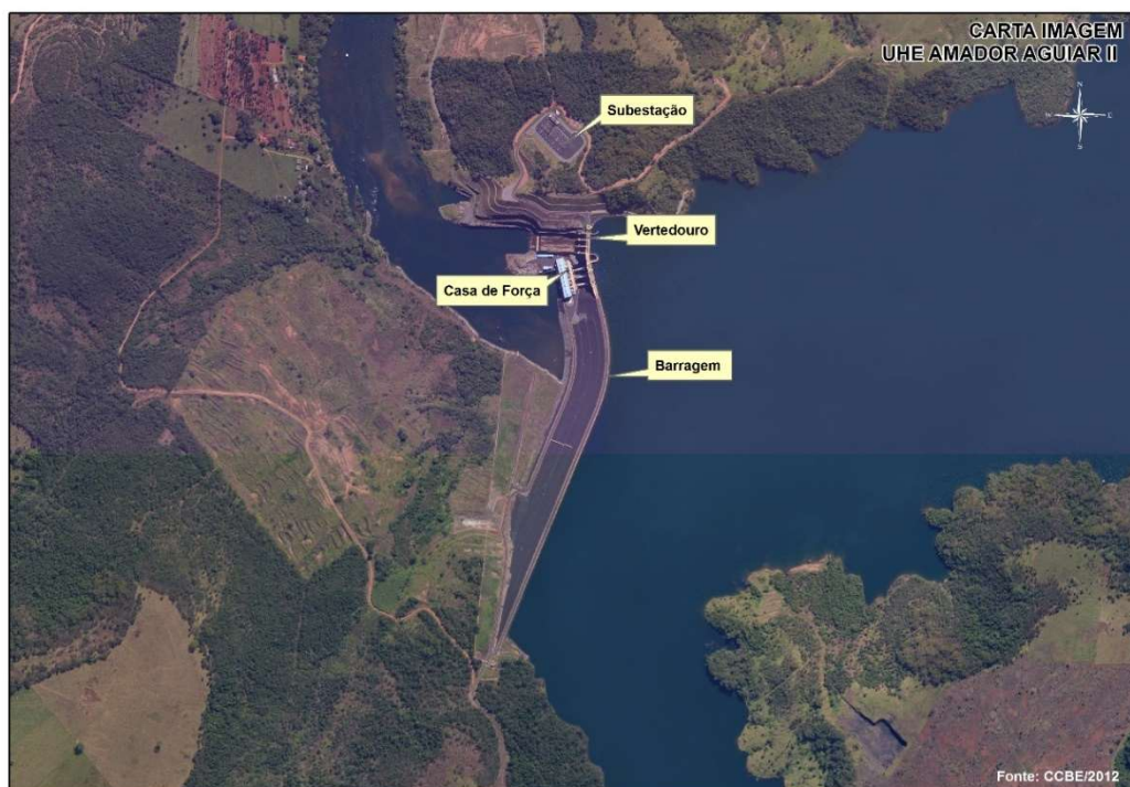
Figura 1 – Arranjo Geral da UHE Amador Aguiar II
