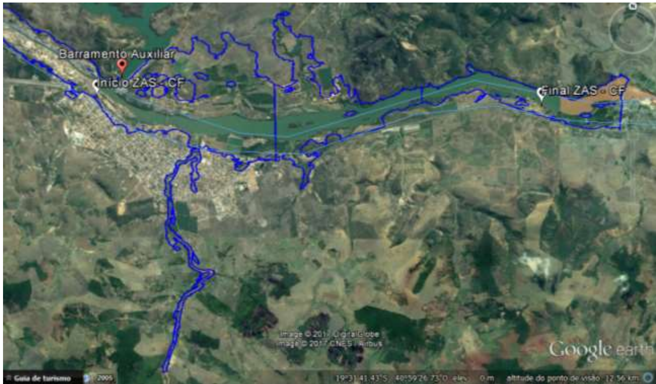
Figura 13: Zona de Autossalvamento no vale a jusante do Barramento Auxiliar da UHE Aimorés. Fonte: Google Earth
