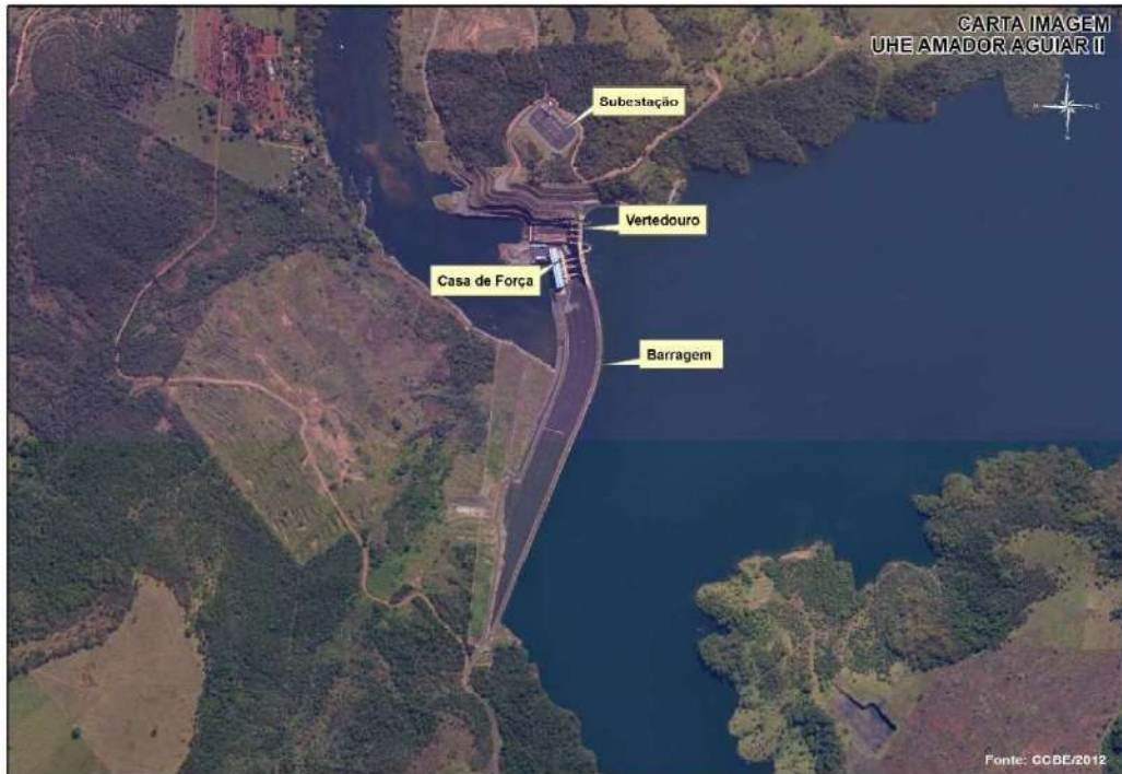
Figura 1 – Arranjo Geral da UHE Amador Aguiar II.
