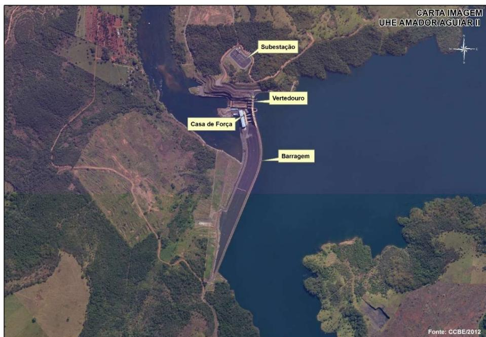
Figura 1 – Arranjo Geral da UHE Amador Aguiar II.
