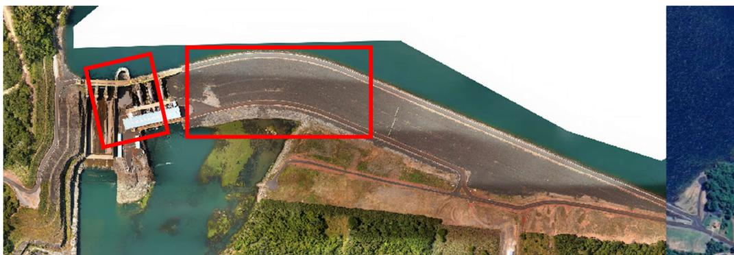
Figura 11. Locais susceptíveis a falha – Barragem principal e Tomada D'Água.
