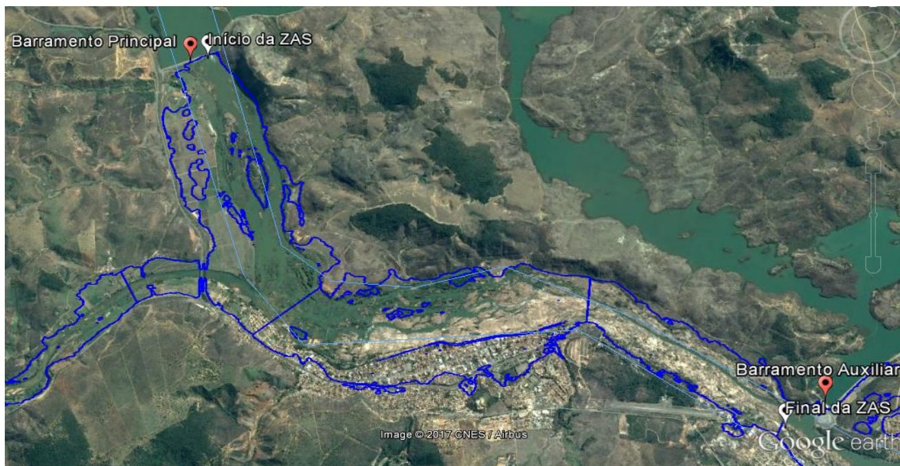
Figura 12: Zona de Autossalvamento no vale a jusante do Barramento Principal da UHE Aimorés.
